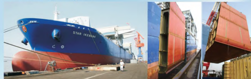
挪威/新加坡籍通用集装箱系列船“斯达”轮共计11艘，从184.5米加长为198米
